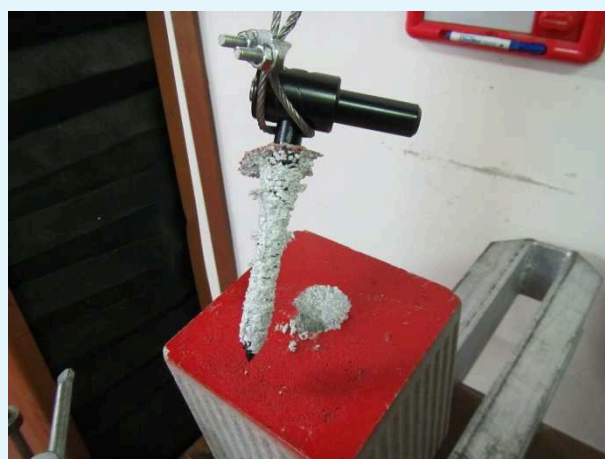
Fotografie dei sistemi di fissaggio al termine della prova.
